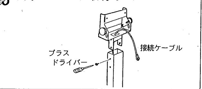
表示ステーに接続ケーブルを通して、向きに注意しながらポールに取付けます。
