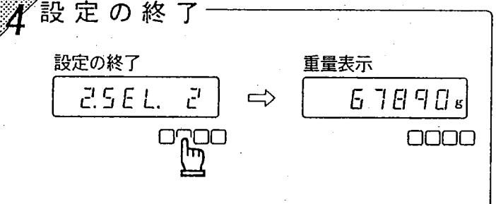
[S]キーを押すと、設定を中断して元の測定モード戻ります。
