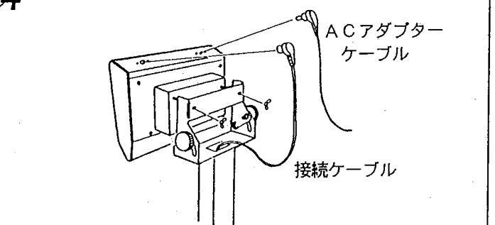
表示ステーに表示部を取り付け、接続ケーブルとアダプターを接続します。
