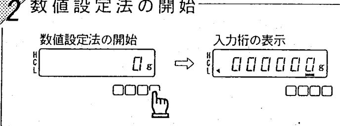
T キーを押すと、全桁が表示されて数値設定法となります。数値の下にバーグラフが点き、入力できる桁である事を知らせます。
