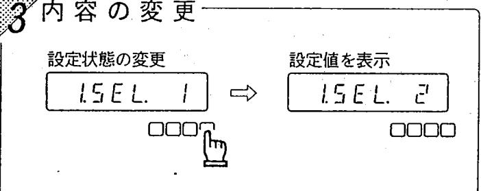
設定を変更したい機能項目が表示している時、[T]キーを押します。右端の数値が変わり、設定状態を選択できます。希望の設定値を選びます。
