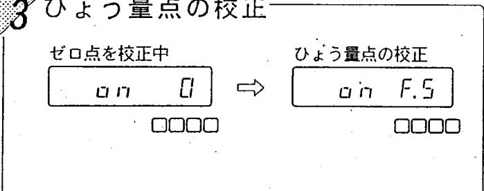
ゼロ点の校正が終わると自動的に表示が変わり、ひょう量点の校正に移ります。
