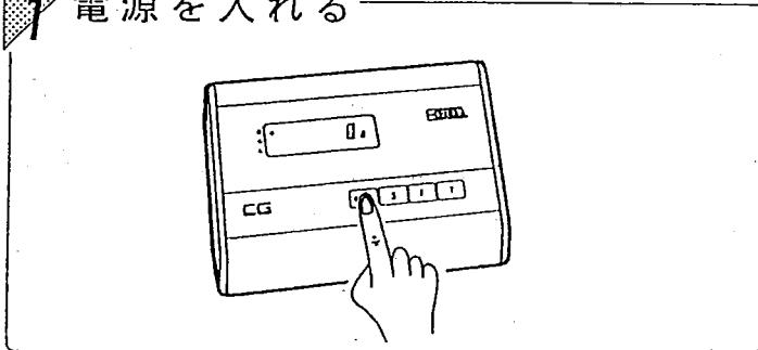
パネルの **ON/OFF** キーを押すと、全表示が点灯して動作状態となります。
