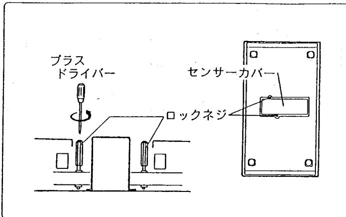
センサー カバー(計量器中央)の両側にある赤いロックネジを、時計と反対方向に止まるまで回します。左図の様に、機構部がフリー状態となりロックが解除されます。
