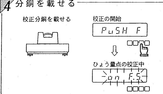
校正分銅を載せ始めると表示が『PUSH F.』になります。分銅を載せ終えてから、[F]キーを押します。『ロフ F.5』表示の点滅に変わり、ひょう量点を自動校正します。
