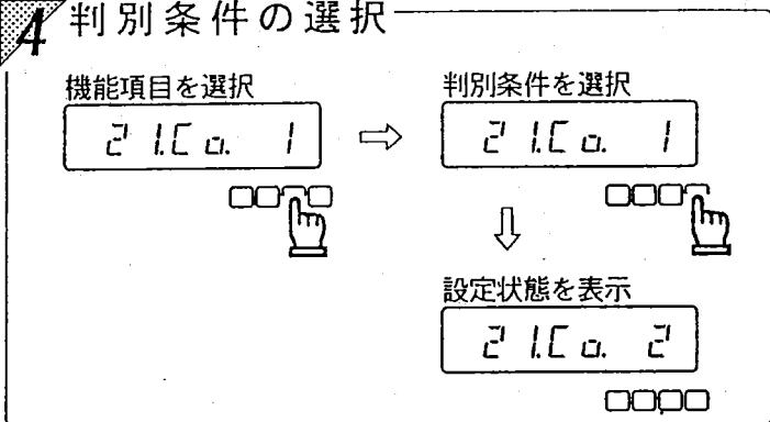
【F】キーを押すと、次の項目「判別条件」が選択されます。【T】キーを押して、判別条件を希望の設定状態に選択します。
