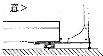
ポールを使用する場合は水平調整後、ポールベース後方にあるツマミを回して床に着くと、表示器が振れにくくなります。
