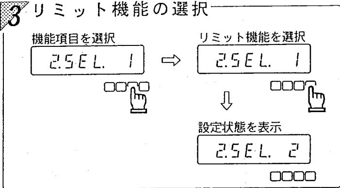
【F】キーを押すと、次の項目「リミット機能」が選択されます。【T】キーを押して、リミット機能『2.5EL. 2』の動作状態に選択します。
