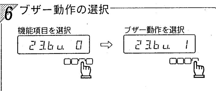
【F】キーを押すと、次の項目「ブザーの動作」が選択されます。4と同様に【T】キーを押して、ブザーの動作を希望の設定状態に選択します。
