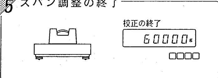
ひょう量点の校正が終わると、元の測定モードに戻ります。
