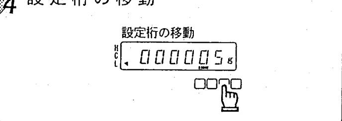
F キーを押すと、バーグラフが左に移り、入力する桁が変わります。最上位桁はバーグラフが点きませんが、符号(+, -)の設定です。
