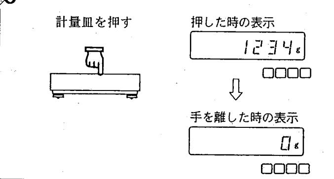
計量皿を軽く押し、表示が変化する事を確認します。また、手を離すと表示が元に戻る（ゼロ表示となる）事を確認してください。
