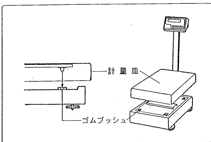
計量器と計量皿のすき間を、前後左右が均一になる様に計量皿を載せます。
