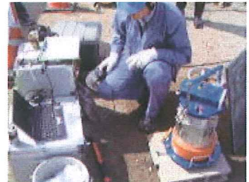
「容器+試料+水」質量を測定する
