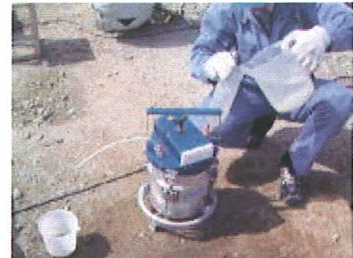
「容器+試料」質量測定後、注水する
