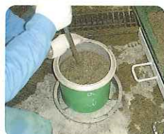
JIS A 1128に従い試料を 容器にをつめる
