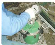
JIS A 1128に従い空気量を 測定する(測定空気量)
