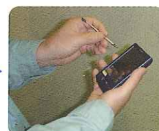
PDAに測定空気量、測定質量を 入力して迅速に単位水量を推定
