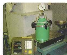
エアメータの質量を量る (測定質量)
