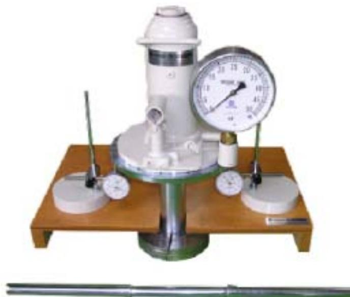
OJ式現場CBR試験装置はJIS A 1211に規定されるとおりの油圧ジャッキを使用した現場CBR試験装置で、油圧ジャッキは50kNのもので最小目盛1kNのブルドン管式圧力計を使用しています。
