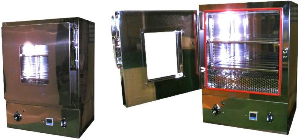
本器は骨材のフルイ分け試験で、骨材を定重量になるまで乾燥する時骨材の含水率の測定、吸収量の測定で乾燥させる時に用いるもので、其の他のあらゆる試験にも用いられる、必要欠くべからざるものです。
