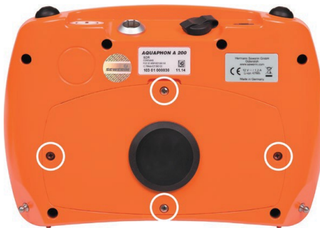
図 30: A 200 受信機裏 充電電池収納部カバーネジ部（白丸）
