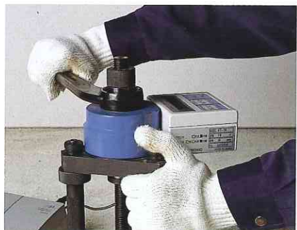
メガネレンチでナットを 締めながら測定する
