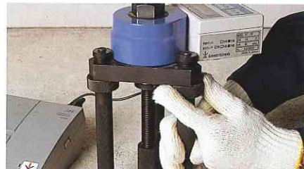
床面の凹凸に合わせて 脚の高さを調節する
