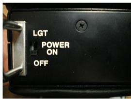
② 電源スイッチを[POWER ON]の位置に合わせます。※バックライト使用時は[LGT] の位置に合わせます。
