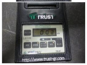
VII 一度電源を落として、再度起動させると、 表示は接続している荷重計の 画面になります。
