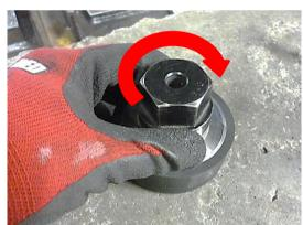
⑤ カプラを設置します。カプラを設置 する際は必ず④と⑤で説明された座金を 間に挟んで下さい。
