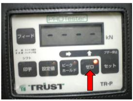
⑦ [ゼロ]ボタンを押し、ゼロ設定をします。表示部に「---」表示後、通常表示に戻ります。
