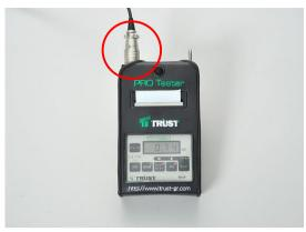
① デジタルプリンター付表示機の 入力コネクタにセンターホール型 荷重計が接続されていることを 確認します。
