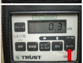
⑤ 点滅している数字に対して[ピークホールド]ボタンで右の桁に移動、[ゼロ]ボタンで数字が増加します。
