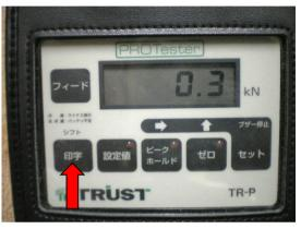
① [印字]ボタンを押し、測定データを プリントします。
