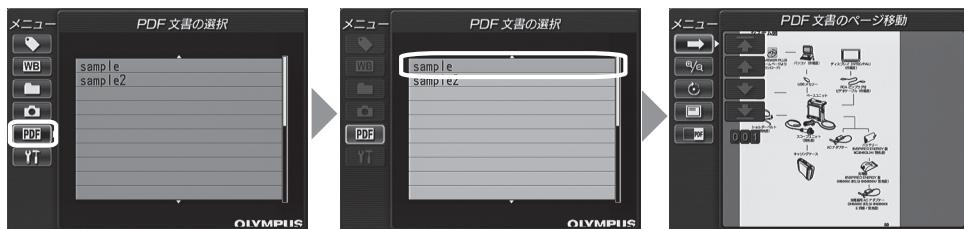
ライブ画面 / フリーズ画面のメニューから、[BRT ▲] / [BRT ▼] ボタンで上下に、[W] / [T] ボタンで左右に操作して、PDF ファイル一覧を表示させます。
