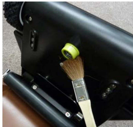
カメラアーム配線、移動用カメラの清掃
