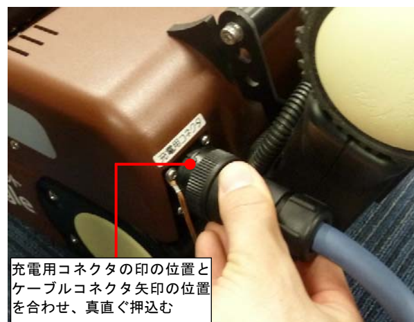
充電ケーブルの取付け
