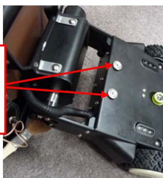
⑤カメラアーム部 固定マグネット 固定ネジ2箇所
