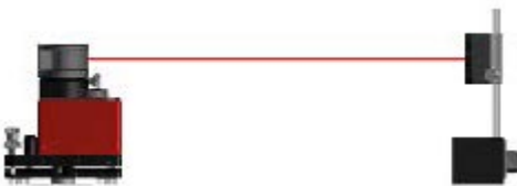
レーザー発信器と受光器の間 5-10m
