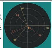
障害：電圧のアンバランス・逆相電圧・高調波の発生などにより、モータの回転ムラや3Eブレーカのトリップ、トランスの過負荷発熱など事故につながる可能性があります。
