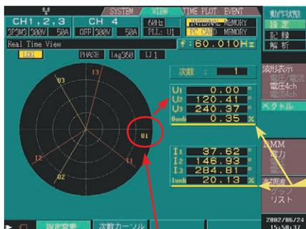
三相測定時には不平衡率を表示します。(3P3W3M, 3P4W 設定時)
