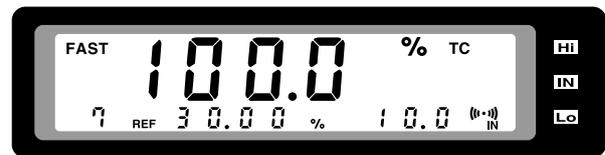
サンプリング FAST、基準値との偏差表示 100.0%（偏差表示＝測定値÷基準値×100%）、温度補正機能 ON、テーブル No.7、基準値 30.00、範囲±10.0%、ブザーモード IN の表示例
