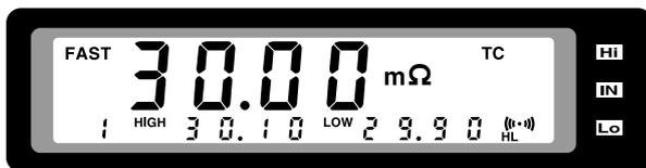
サンプリング FAST、測定値 30.00 mΩ、温度補正機能 ON
