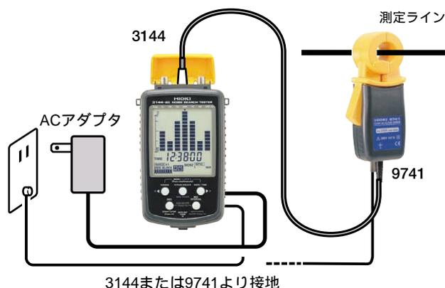
3144は500Hz～30MHzの帯域のノイズを7帯域に分離して測定、各周波数レンジの測定電圧をレベルメータで表示します。
