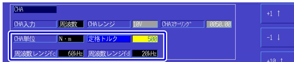
(例 2) 定格トルク 2 kN・m、正定格トルク 15 kHz、負定格トルク 5 kHz のトルクセンサのとき
