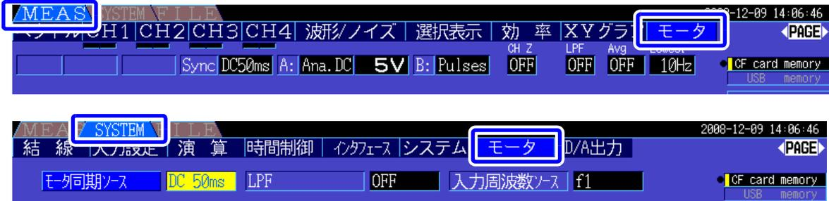
モータ解析機能は、トルクセンサやロータリーエンコーダなど回転計からの信号を取り込み、モータ解析項目「トルク、回転数、モータパワー、すべり」の測定ができます。「4.7 効率・損失の測定値を見る」(⇒ p.77) の機能と組み合わせると、モータ効率やトータル効率、損失の演算ができます。
