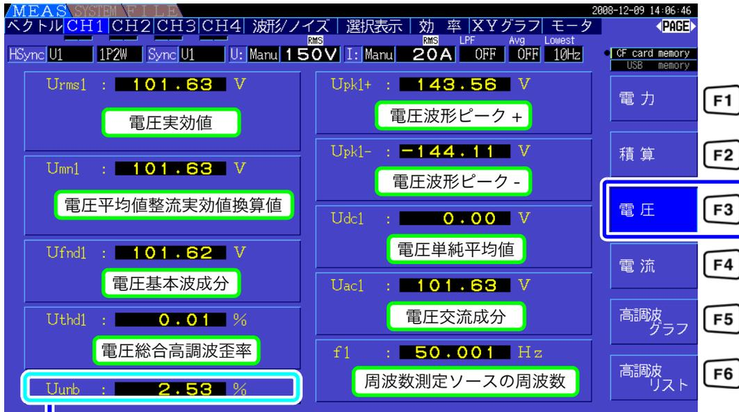
結線モードが 3P3W3M、3P4W の場合は、電圧不平衡率 Uunb[%] が表示されます。
