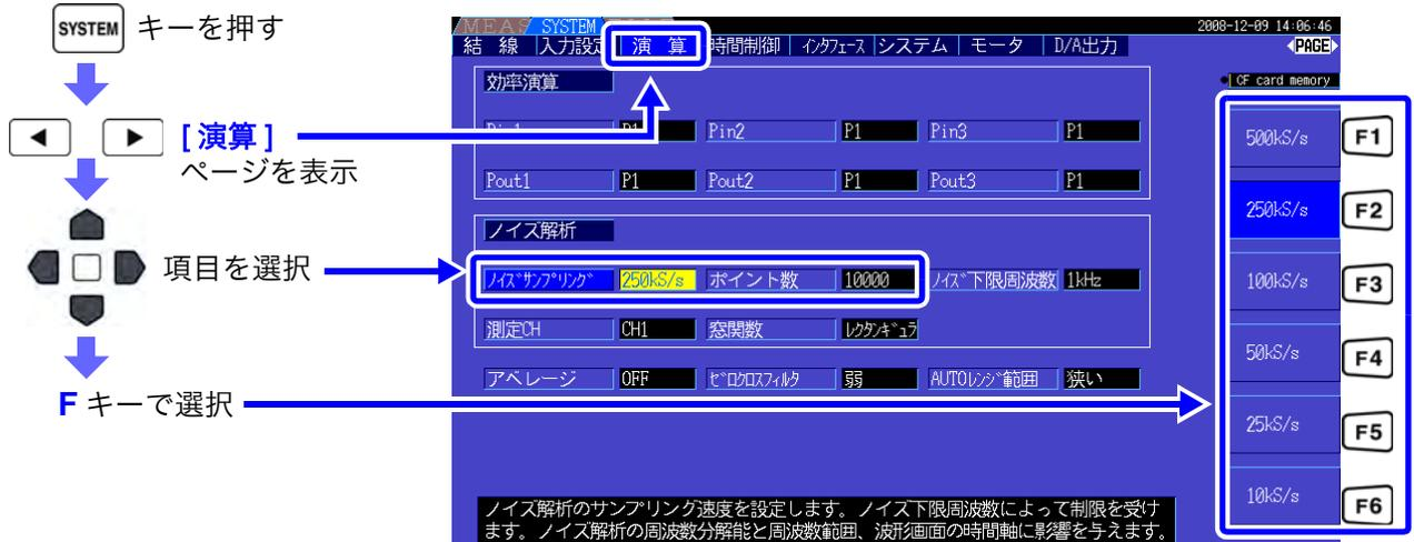
サンプリングは測定画面の**【波形/ノイズ】**ページで、**【ノイズ】**を選択した画面でも設定できます。
