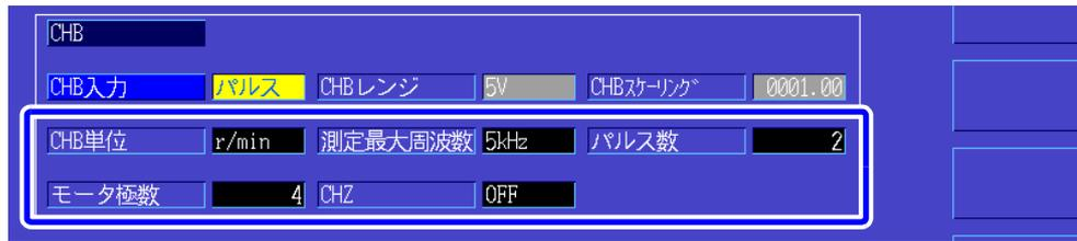
**CH B 単位** モータパワー (Pm) を測定する場合は、必ず [r/min] を選択してください。
