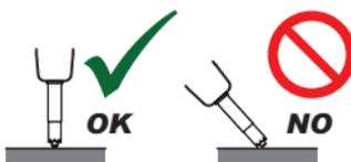
温度プローブ先端に過度の衝撃を加えたり、リード線を無理に曲げたりしないでください。故障や断線の原因になります。
