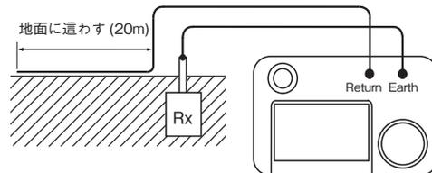
架空通信設備／各種保安器等に用いられる棒状電極の接地抵抗測定が簡単
