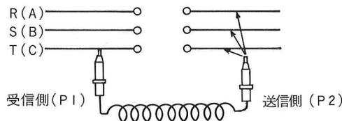
1. 受信側を線路に接触させる → 受信側は発音発光する。
