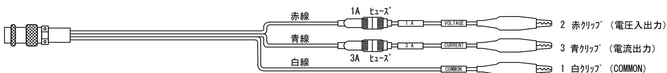
2645形 G R / L G A試験用電流出力コード
