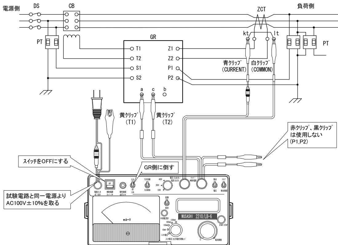
図2 高圧受電設備の電源を生かした状態でのGR単体試験
