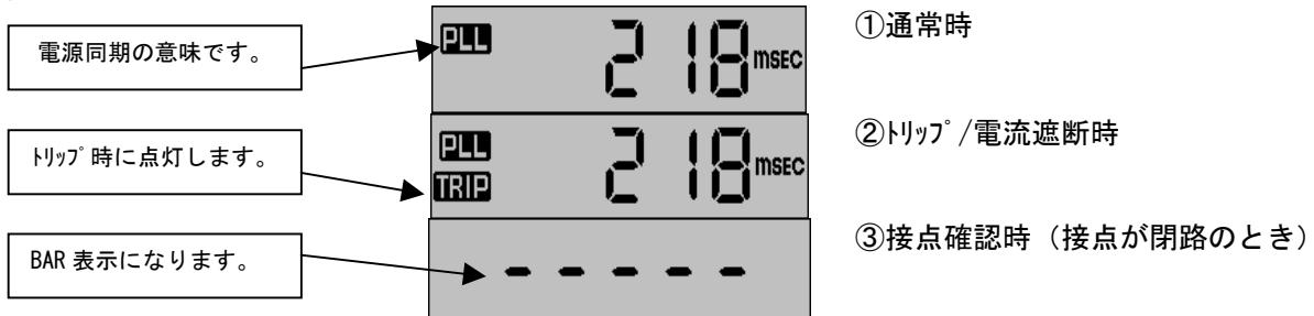
**トリップ検出機能と性能****接点（無電圧接点）検出方式**
