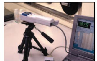
3444(長焦点狭視野測定用)と3445(短距離スポット測定用)は、オプションのインタフェースパック3909を使用して、記録計やパソコンに測定データをリアルタイムで出力できます。長時間の温度変動/異常監視に威力を発揮します。
