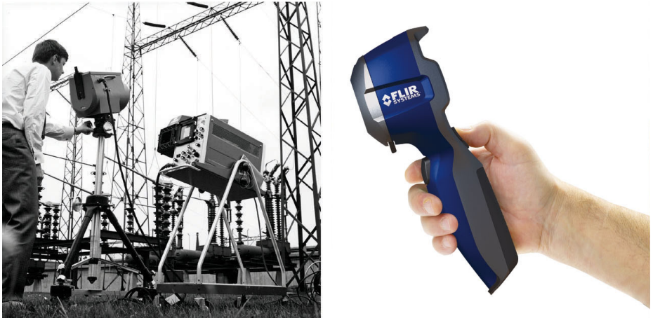
図 16.2 左Thermovision® Model 661、1969年発売カメラの重量は約25 kg (55 lb.)、オシロスコープは20 kg (44 lb.)、三脚は15 kg (33 lb.)です。オペレータは220 VACジェネレーターセットと、液体窒素の入った10 L (2.6 USガロン) 容器も必要です。オシロスコープの左側には、ポラロイドのアタッチメント (6 kg/13 lb.)があります。右: FLIR i7、2009年発売重量:0.34 kg (0.75 lb.)、バッテリーを含む
