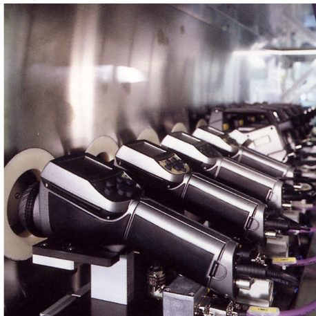
図 16.5 左: 気候室での赤外線カメラの試験。右: カメラテストおよびキャリブレーション用ロボット
