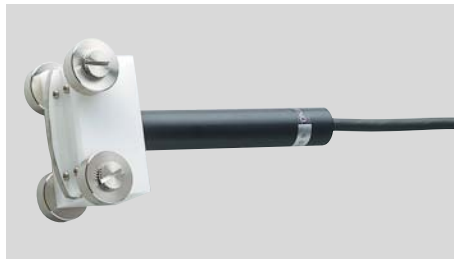
●SK-S402K 回転表面用（ローラ型） 0~300℃ 25×50×25mm 取っ手部φ15×ℓ90mm コード1.1m付 (センサ精度 クラス2)
