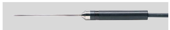
●SK-S101T 食品、ゴム質用先トガリ 液体、粘性体、半固体用 -30~199.9℃ φ3×ℓ100mm コード1.1m付 No.8080-82
