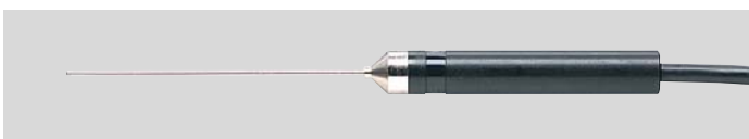
●SK-S100T 標準センサ 液体、粘性体、半固体用 -30~199.9℃ φ2×ℓ100mm コード1.1m付 No.8080-80
