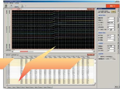
PCから付属ソフトウェア Logger Utility を使って、リアルタイムにデータをパソコンに記録します。ウィンドウ内でトレンドグラフを観測し、記録中でも過去の波形に逆スクロールして観測する事が可能です。
