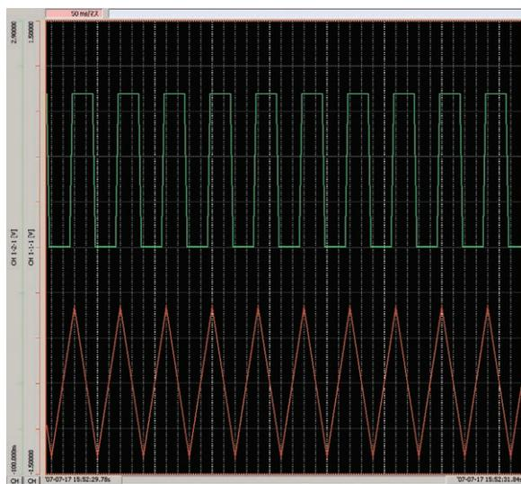
5Hz のパルス波形を、10msec (上段)と100msec (下段)でサンプリングした比較例 (付属 Logger Utility ソフト使用)
