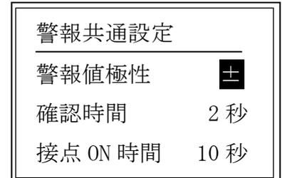
全ての警報設定値を設定すれば、設定変更の確認画面が表示されます。「はい」を選択すれば、警報設定値が新しい設定値に変更されます。「いいえ」を選択すれば、設定変更はキャンセルされ、警報設定選択画面に戻ります。
