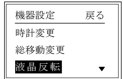
液晶反転画面に移れば、液晶反転の確認画面が表示されます。「はい」を選択すれば、液晶反転を実行します。「いいえ」を選択すれば、機器設定選択画面に戻ります。
