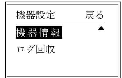
機器情報確認画面に移れば、機器名称・型番(装置名)・プログラムバージョン・製造番号(装置番号)・機器内部温度が表示されます。液晶表示ボタンを押すと、機器設定選択画面に戻ります。
