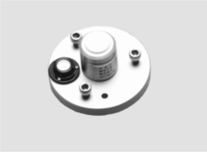
日射計ソーラーミニは、地表面上の全天日射量を測定する非常に低価格なセンサーです。受感部に約100対の熱電対を使用していますので、高感度で高精度、経済性に優れた日射計です。特殊仕様の拡散板は日射量を的確に捕らえることができますので、微気象観測に用いるのに適しています。
