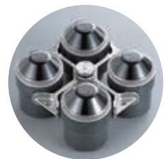
多目的スイングロータ SF-5004 500mLボトルが4,000rpm/ 3,080×gで遠心可能です。
