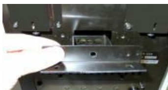
固定金具Bを取り付ける
