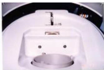
回転トレイを手で回し、回転メカニズムのねじ穴を合わせる
