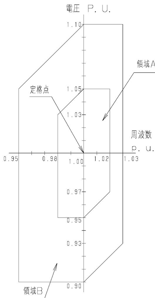
図5. 電源電圧及び周波数の変動域
