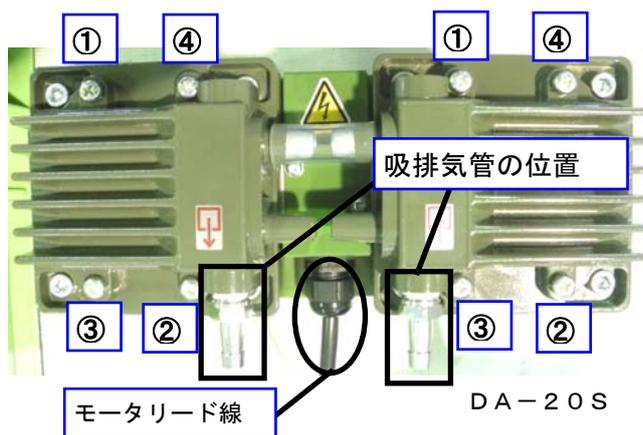
手順10：ポンプヘッドカバーを取付けます。DA-20DとDA-40Sではポンプヘッドカバーを取付ける向きが異なりますので図を参照して間違えないようご注意ください。
