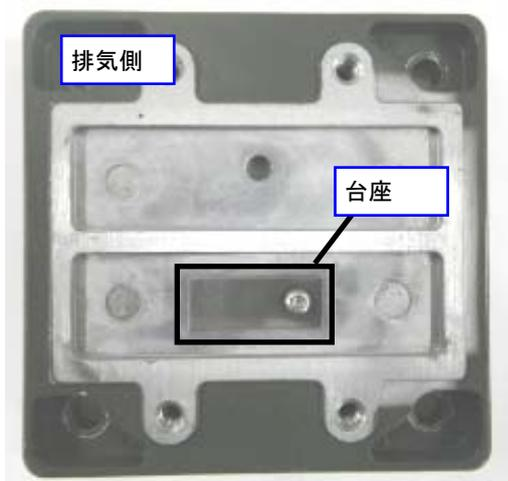
手順6：吸気側の吸排気弁を取り付けます。手順3で取り外した吸排気弁を新しいものと交換してください。吸排気弁、平座金、ナベ小ネジ（M3×5）の順に取り付けてください。平座金は、丸みのある方をポンプヘッドに向けて設置してください。ネジ締め付けの際、ネジにはネジ先2～3山にロックタイト242を塗付し、トルクドライバー（0.8N・m）で締め付けてください。吸排気弁は図を参照し、正しい位置に取り付けてください。
