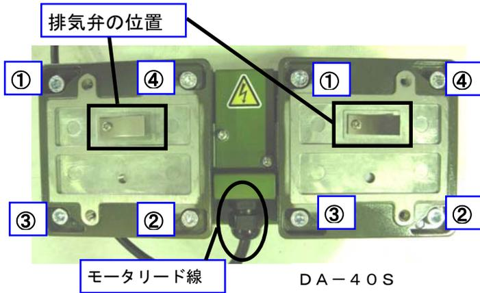
手順8：ポンプヘッドを取付けます。DA-20DとDA-40Sではポンプヘッドを取付ける向きが異なりますので図を参照して間違えないようご注意ください。
