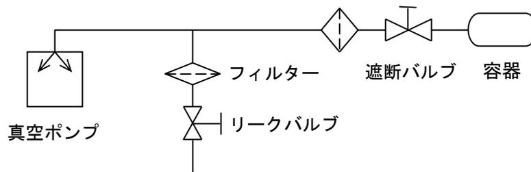
図6. 容器を真空排気する場合の配管例
