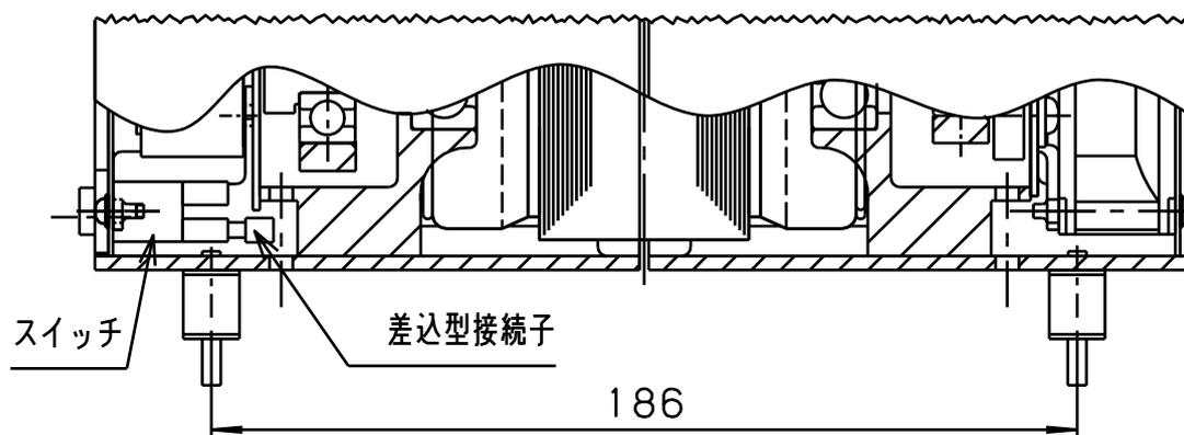
図3. 防振ゴム取付け時の取り合い
