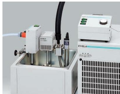
低温での各種実験に適したシステムです。温度調節器、攪拌ポンプ、自動給水装置、投込みヒータなどを組合せて構成できます。
