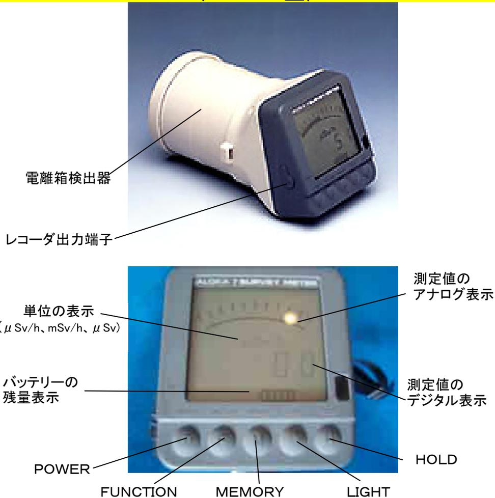
写真1 電離箱式サーベイメーター(ICS-321型)
