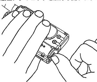
電池が入っていないときは、防水/パッキンにより底面フタが起き上がらないことがあります。ロックを解除しながらフタの側面を爪で軽く上げると底面フタは開きます。
