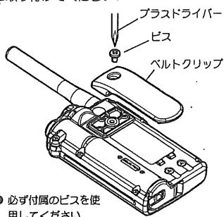
ベルトにベルトクリップを通して確実に取り付けてください。
