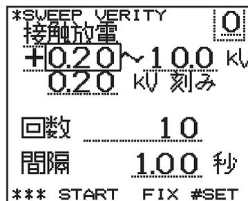
出力電圧のステップアップを自動的にに行います。
