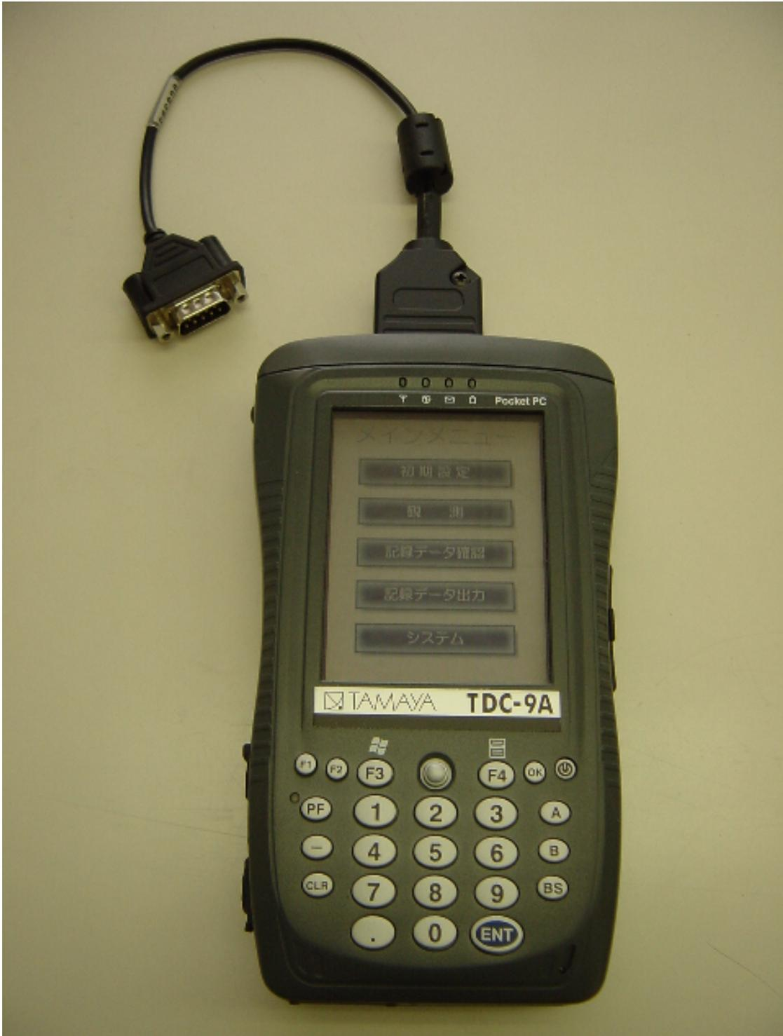
本データコレクタ「TDC-9A」はTAMAYAデジタル音響測探機「TDM-9000A」の観測データをRS-232Cインターフェイスから取り込み、本体メモリーまたはSDカードメモリーに記録します。
