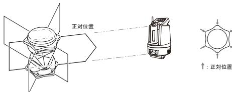
ATP2SII: プリズム上面の 6 本の印を直線に結ぶ線が、水平方向の正対位置です。
