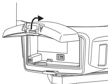
2. バッテリーの端子の向きを確認して、バッテリーを本体に押し付けて、右側にスライドさせて取り付ける
