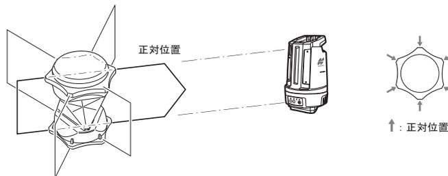
ATP2SII : プリズム上面の6本の印を直線に結ぶ線が、水平方向の正対位置です。
