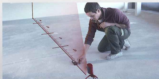
Line laser + Leica DISTO™ – ラインレーザーとステイクアウトファンクションによる位置決め (D8, D5, D3a, D2)
