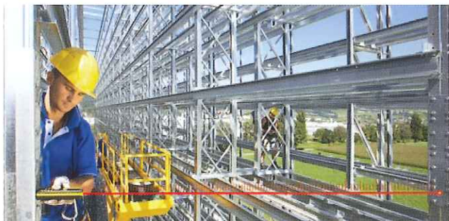
Storable – デジタル ポイント ファインダーによる屋外での測距 (D8, D5)
