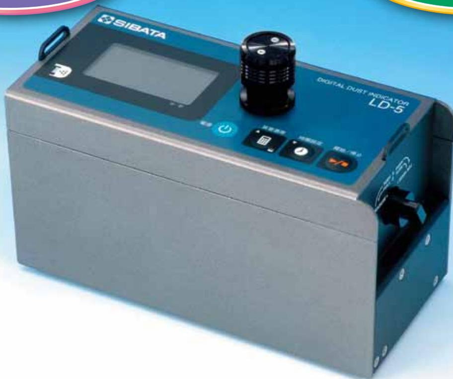
LD-5は内蔵ポンプにより一定の吸引流量で浮遊粒子状物質を器内に導き測定をおこなう光散乱方式の相対濃度計です。
