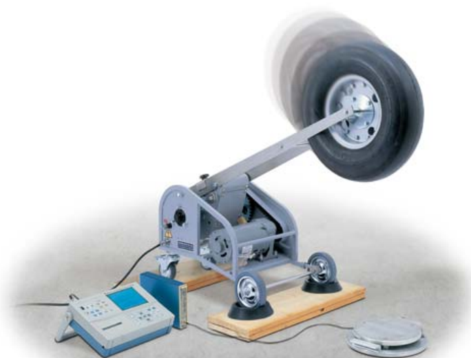
● バングマシン衝撃力測定例
