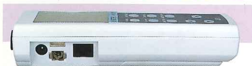
アナログ/プリンタ/RS-232C出力、ACアダプタ入力端子。
