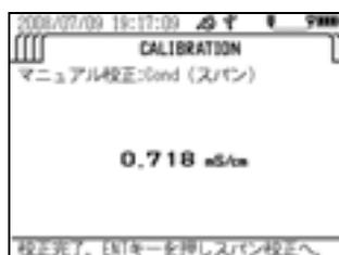
18. 校正カップ（透明）を純水で 2 ～ 3 回洗浄し、0.667 S/m（6.67 mS/cm）の標準液を校正カップ（透明）の標線まで入れます。
