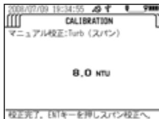
15. 校正カップ（透明）を純水で 2 ～ 3 回洗浄し、80 NTU または既知の 10 ～ 100NTU までの標準液を校正カップ（透明）の標線まで入れます。
