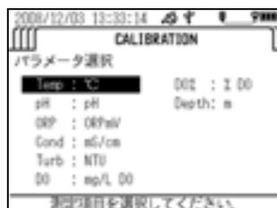
5. センサプローブを浸漬させた水の温度を校正値として、△▽ キーを押して設定します。
