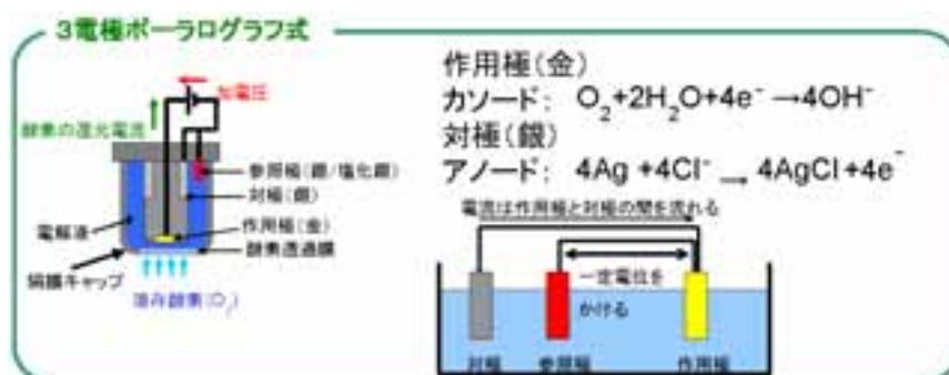
図 1 溶存酸素センサの原理概要図
