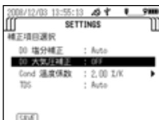
5. 「入力モード」の場合、▷ キーを押すと、補正值入力画面になります。△ ▽ キーを押し、任意の数値に設定して、ENTER キーを押します。
