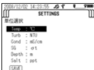
5. 選択リストが表示されます。●印が現在選択されている単位です。△▽ キーを押し、変更したい単位にカーソルを合わせて、ENTER キーを押します。
