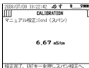
23. 校正カップ（透明）を純水で 2 ～ 3 回洗浄し、5.87 S/m（58.7 mS/cm）の標準液を校正カップ（透明）の標線まで入れます。
