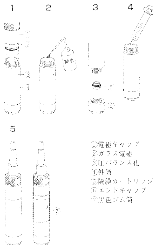
図3 隔膜カートリッジの交換方法
