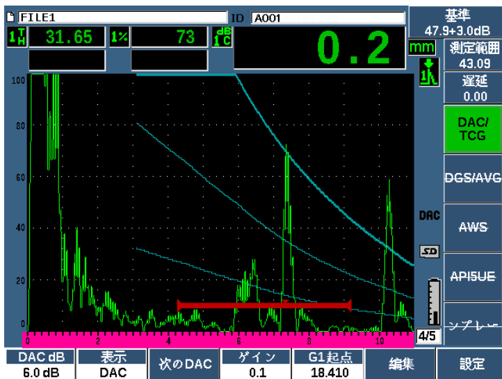
図 11-11 DAC 調整によるゲインカーブ
