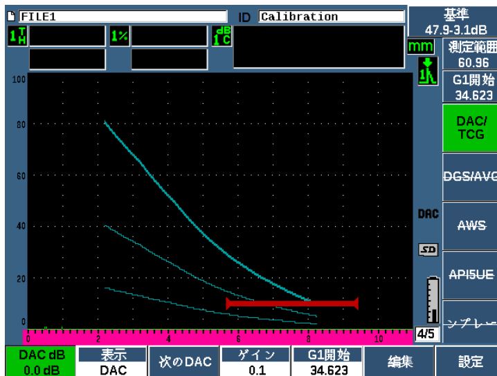
図 11-6 完成した DAC カーブ
