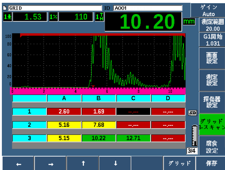
図 11-37 腐食検査用モジュールのグリッド表示
