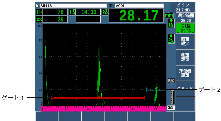
図 4-8 ゲートのある A- スキャン波形の例
