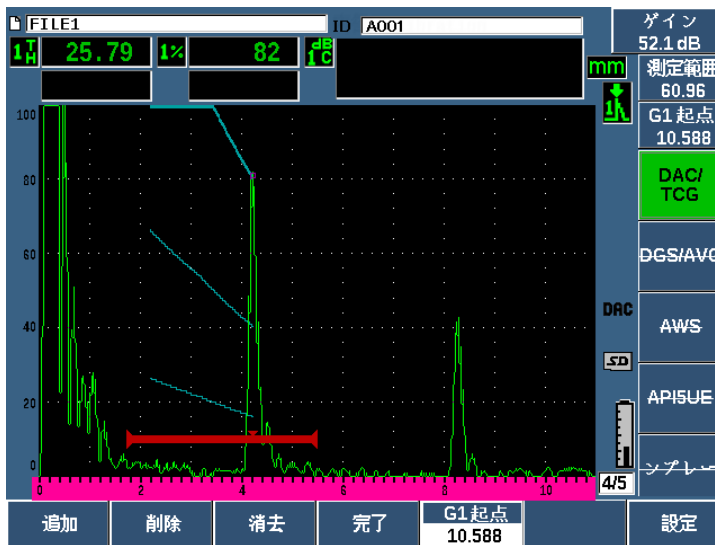
図 11-5 各エコーを 80%FSH に設定した部分的な DAC カーブ
