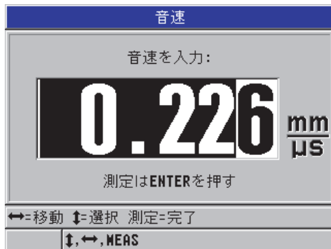
図 5-9 既知の材料音速の入力
