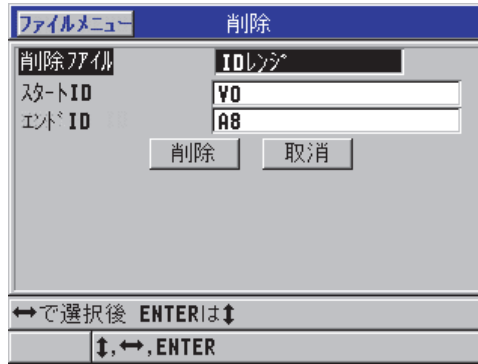
図 6-32 アクティブファイルでの ID 範囲のデータの削除
