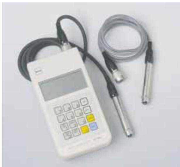
磁性金属上と非磁性金属上の被膜の両方を測れるデュアルタイプの膜厚計です。上位器種のLZ-330Jから統計処理機能とプリンタ対応機能を除いた仕様となっています。膜厚測定は近年、素材の多様化から鉄素材と非鉄金属素材の混在化が著しく、それに対応すべくデュアルタイプの膜厚計が望まれています。本器はプローブの交換で簡単に両素材の被膜が測れます。
