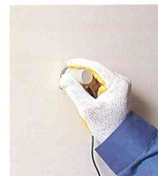
●探触子を測定位置に密着させます。
