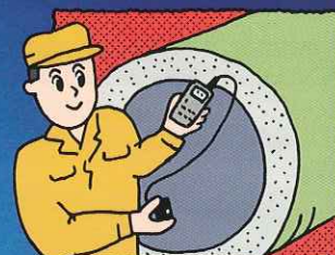
▲ライニング膜の皮膜厚測定
