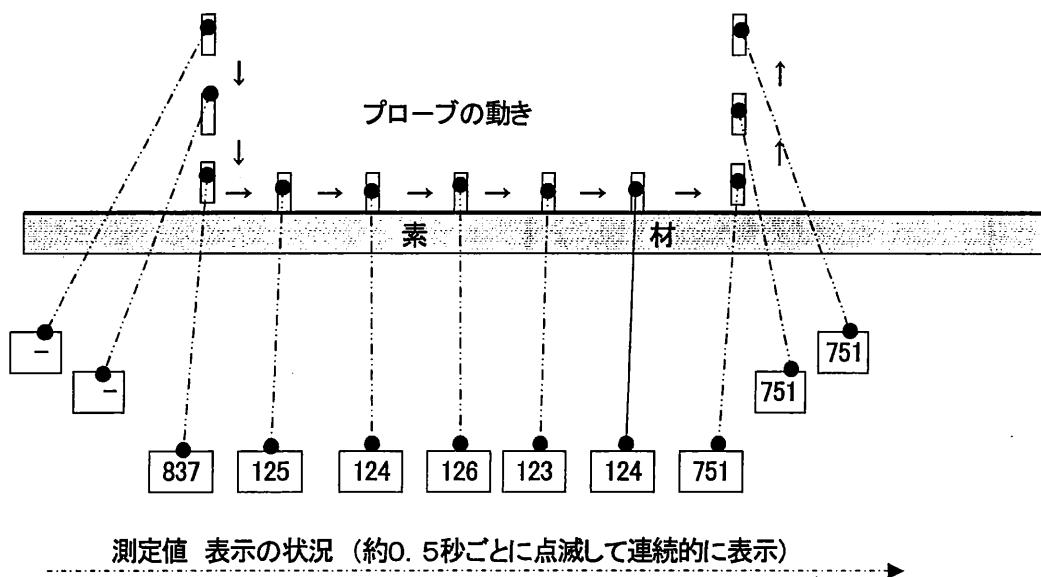
※この連続測定の機能は電源 OFF しても継続され、次回の電源 ON 時にも利用できます。
