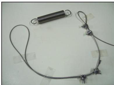
② レールエンドの穴を通し配管に巻き付けバネに引っ掛け固定します。
