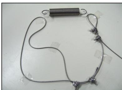
② レールエンドの穴を通し配管の大きさに長さを調整します。配管に巻き付けバネに引っ掛け固定します。
