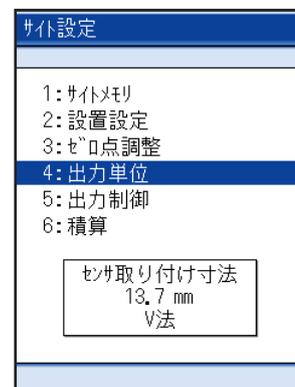
② ▲▼キーを押して、単位の変更を行いたい出力項目に、カーソルを移動させます。
