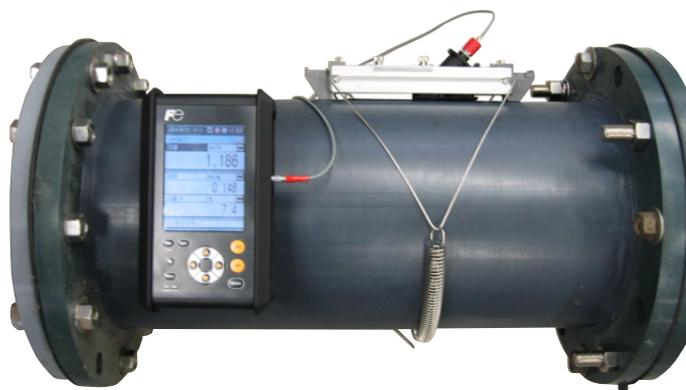
2. 2 測線の場合は上流側（UP STREAM）、下流側（DOWNSTREAM）の両方に接続してください。
