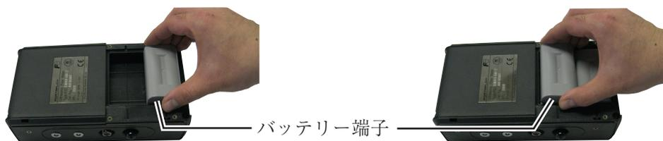
(3) バッテリー 2 個の装着を完了する
