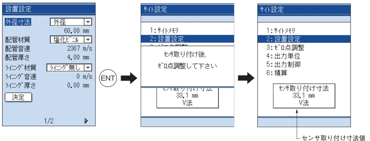
表示された寸法値で8項の検出器取付けで検出器を取り付けてください。
