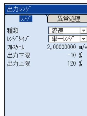
②出力レンジの種類（流速，流量，熱流量）を設定します。
