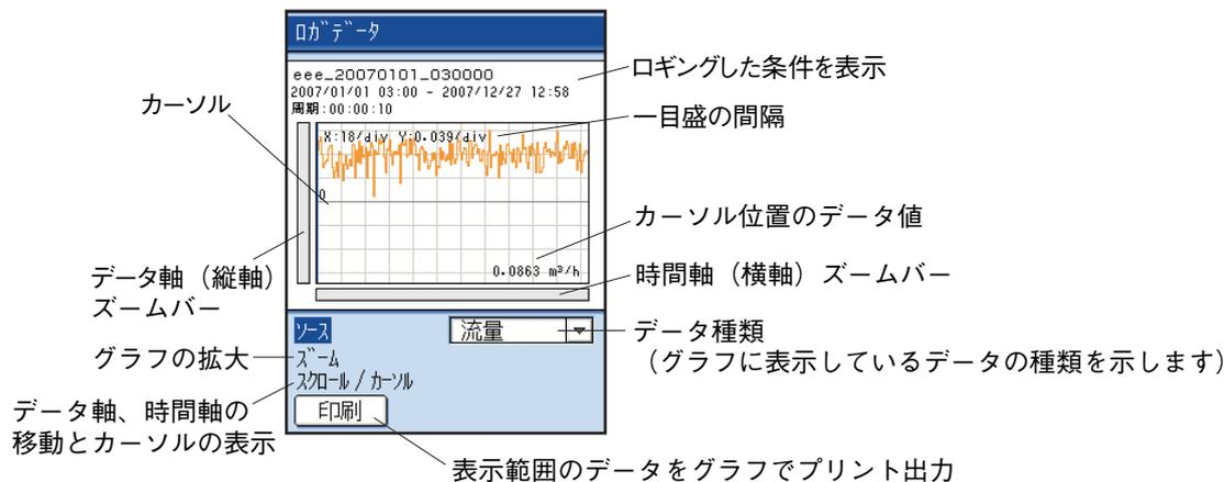
ロギング開始から最大4画面分のロギングデータを表示します。データ数で最大816データとなります。（1画面204データ）
