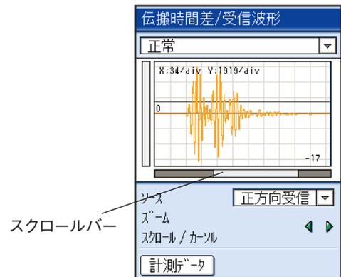
⑦ 時間軸の移動を微調整したい場合▲ ▼キーで「カーソル」にカーソルを合わせて(ENT)キーを押しますと、移動可能状態になります。
