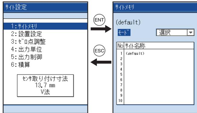
② 「モード」にカーソルを移動し、ENTキーを押しますとモードの選択画面が開きます。
