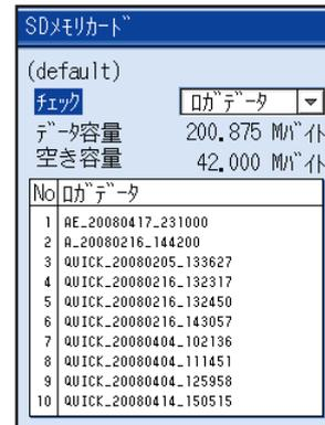
③ (▲) (▼) キーで確認したいデータ項目 (ログデータ, 画面コピーデータ, 流速分布データ) にカーソルを移動させて(ENT)キーを押してください。
