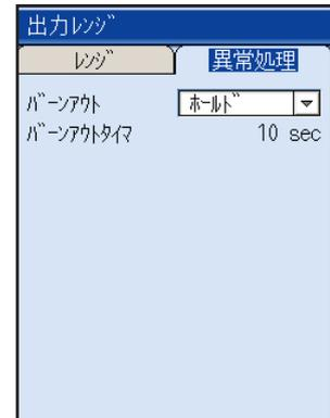
② バーンアウト時の処置方法を設定します。
