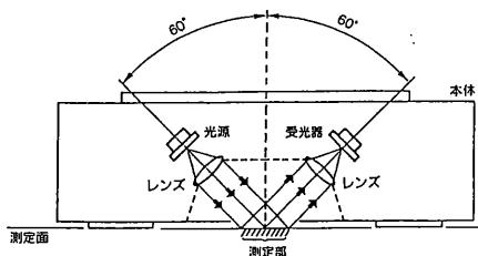
光沢度は、表面に光をあてた時の反射の程度を表す量で、測定部分での反射光の強さと、光沢基準板からの反射光の強さの比で決められています。
