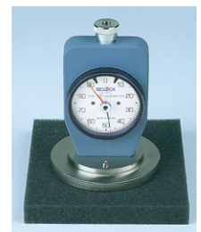
GS-744Gをスポンジシートに置いて、硬さを測定しています。発泡度合の分散性も判定できます。
